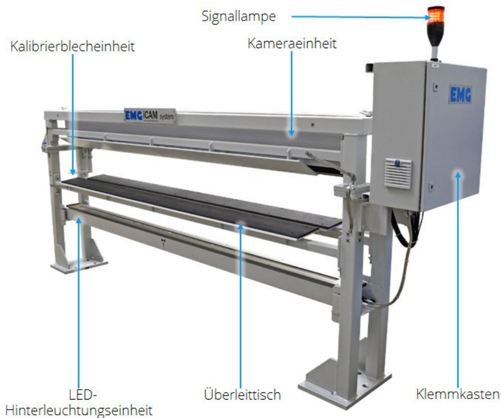
EMG iCAM® Breitenmesssystem - Kameramodule im oberen Teil, Lichtstrahler (IR-Hintergrundbeleuchtungseinheit) im unteren Teil
